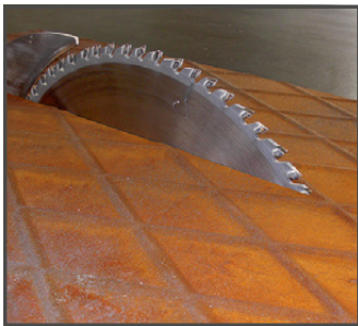
Bearbeitung mit normalen HM-Werkzeugen
